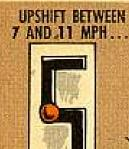
AND EASE UP ON THE GAS SLIGHTLY WHEN SHIFTING.
